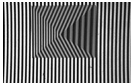
Figura 4. Imagen con un objeto bajo un patrón de Ronchi.
